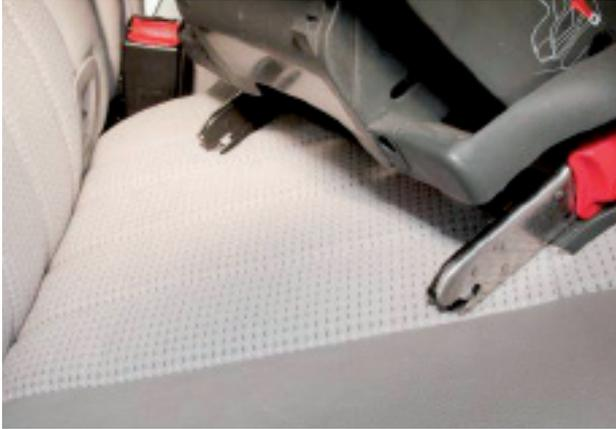
Las sillitas para bebés o portabebés se sujetan al coche bien mediante el cinturón de seguridad del vehículo o bien con el sistema ISOFIX o LATCH (en el caso de que tanto la sillita como el vehículo dispongan de dicho sistema). El sistema ISOFIX y/o LATCH facilita notablemente la tarea de instalar el SRI o la sillita en el vehículo, aumentando así la eficacia del sistema.
